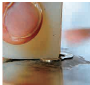
ジャン・ダニエル・ニコラの真骨頂が、部品の焼き入れと焼き戻し。(左) すべての鋼製部品は、木炭の上で焼き入れされる。木炭だと、照り返しで歪みにくいという。(右上) 焼き入れされた部品。この状態だと柔らかいので、焼き戻しを加えていく。(右下) 焼き入れした部品は、すぐにプレスされ歪みを取る。「昔はプレスする人、焼き入れする人と作業が分担されていた」
