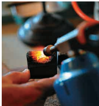
ジャン・ダニエル・ニコラの真骨頂が、部品の焼き入れと焼き戻し。(左) すべての鋼製部品は、木炭の上で焼き入れされる。木炭だと、照り返しで歪みにくいという。(右上) 焼き入れされた部品。この状態だと柔らかいので、焼き戻しを加えていく。(右下) 焼き入れした部品は、すぐにプレスされ歪みを取る。「昔はプレスする人、焼き入れする人と作業が分担されていた」
